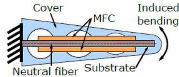
Fig. 2: HFVTE actuator.
